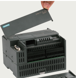
卸掉端子盖板
